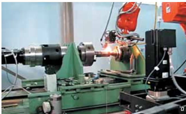
Рис. 3. Процесс восстановления лазерной наплавкой ротора газоперекачивающего оборудования (а) и газотурбинных лопаток (б)
