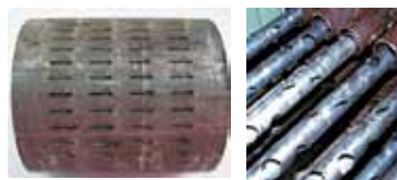
Рис. 4. Примеры лазерной перфорации труб с толщиной стенки 2 мм
