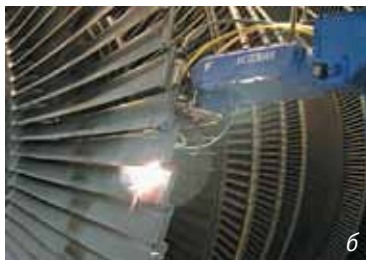
Рис. 3. Процесс восстановления лазерной наплавкой ротора газоперекачивающего оборудования (а) и газотурбинных лопаток (б)
