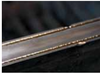
Рис. 6. Лазерная сварка балок из титановых сплавов
