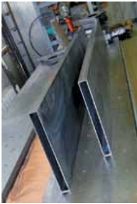
Рис. 6. Лазерная сварка балок из титановых сплавов
