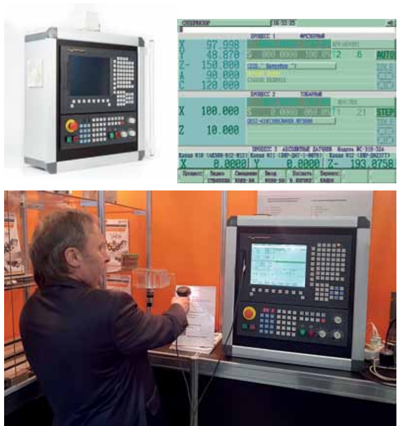
Рис. 1. С помощью сканера штрихкода на УЧПУ NC-400 появилась возможность считать QR-код и вызвать из памяти и запустить управляющую программу, либо внести коррекции инструмента
