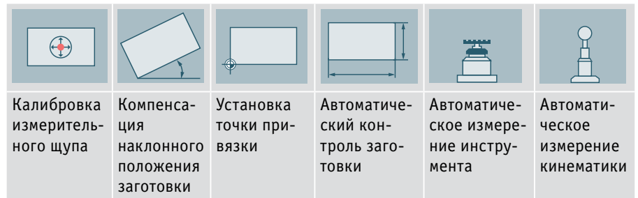
Рис. 5. Циклы измерения в стойке ЧПУ NC-400 компании «Балт-Систем»
