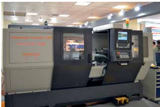
Рис. 11. Токарный станок с прямой станиной 16Ф4П285-1500 с УЧПУ-310 «Балт-Систем», созданный на производственной базе ООО НПП «МЕАТЭК»
