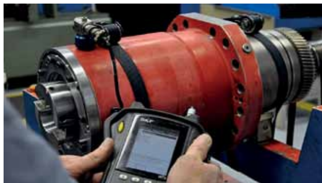
Рис. 1. Диагностика шпинделя с помощью портативного прибора
