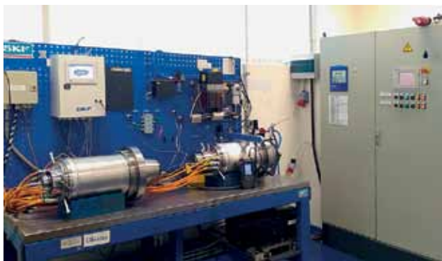
Рис. 2. Стенд обкатки шпинделей в Инжиниринговом центре SKF Solution Factory
