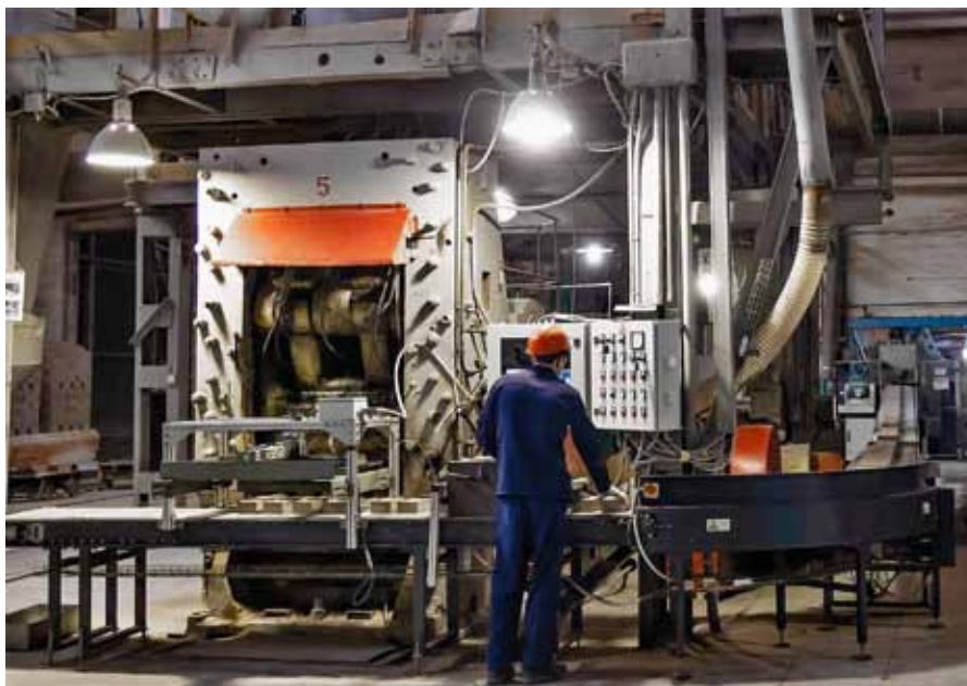
Прессовщик задает схему садки, соответствующую виду изделий
