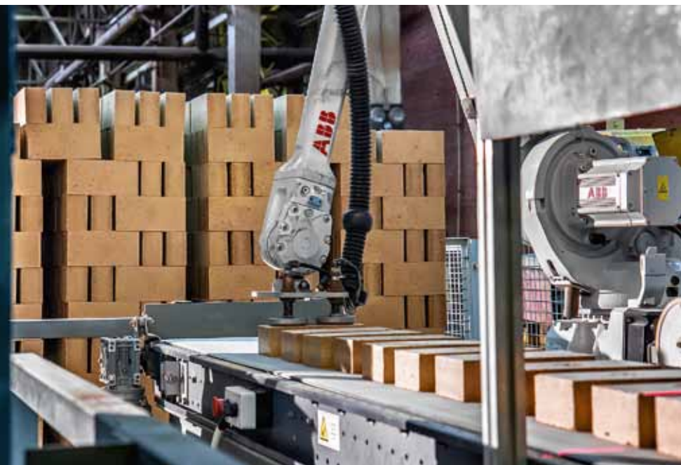
Подача огнеупоров по конвейерной линии для идентификации системой технического зрения
